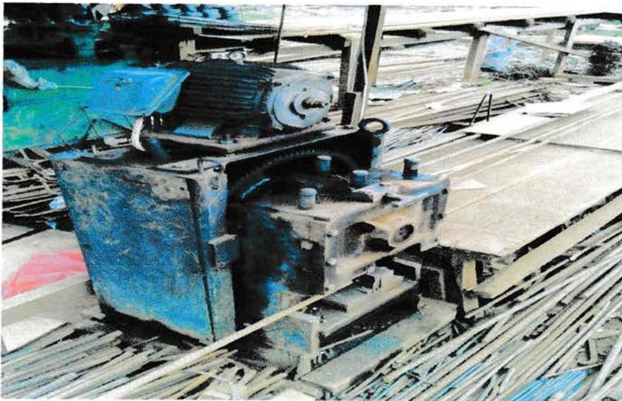
Gambar 14. Mesin Pemotong Besi Tulangan (*Bar Cutter*)
