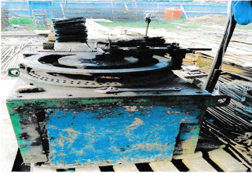
Gambar 15. Mesin Pembengkok Besi Tulangan (*Bar Pending*)
