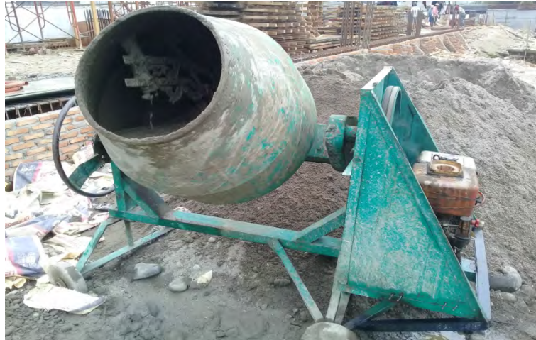
Gambar 3.8 Mixer Beton Mini
