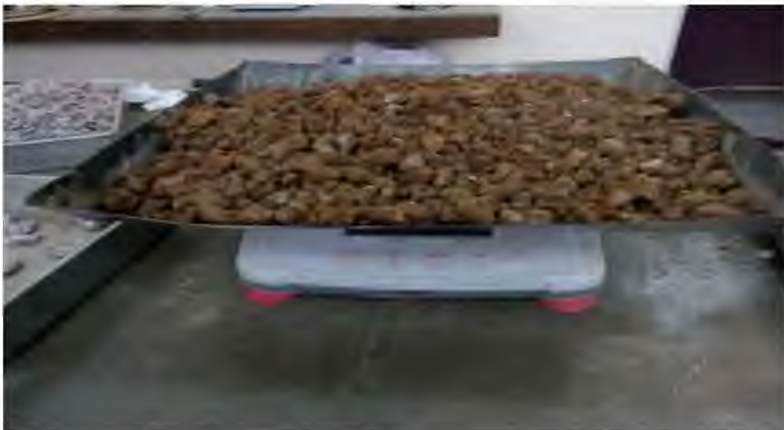
Penimbangan Tanah Setelah Pengovenan
