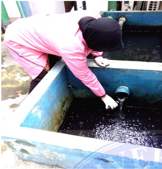
Pengambilan sampel air limbah buangan akhir pada bak buangan akhir di IPAL RSUD Dr. RM. DJOELHAM, Binjai
