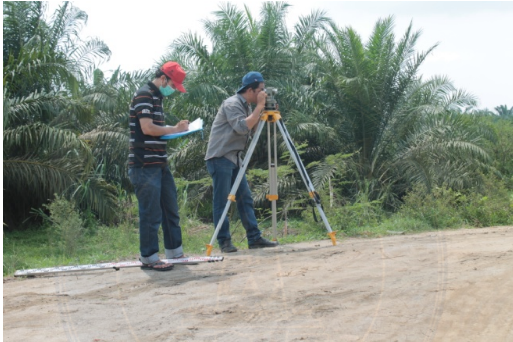
Gambar 3.4 Pengukuran Topografi dengan Total Station
