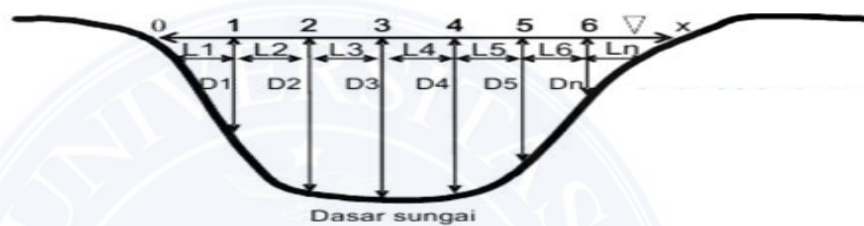
Gambar 2.4 Sketsa Pengukuran Lebar Untuk Setiap Rai2 (Standar Perencanaan Irigasi KP-02)
