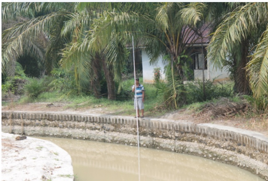
Gambar 3.6 Pengukuran Penampang Melintang dan Memanjang Saluran
