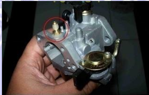
Gambar 3.12 Pemasangan Naple Gas pada Karburator.
