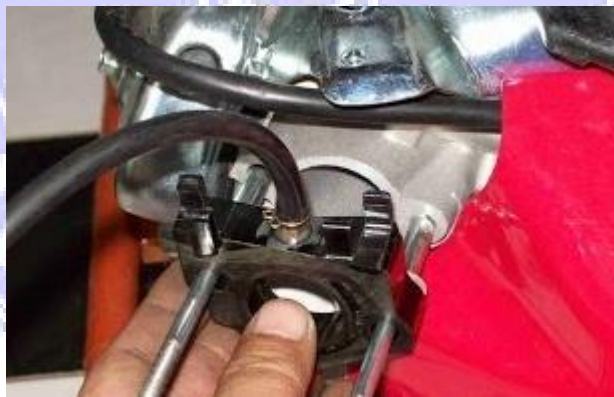
Gambar 3.11 Pemasangan naple vakum isolator yang sudah dimodifikasi
