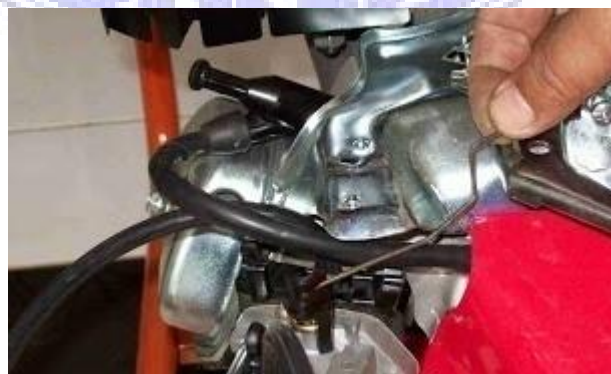
Gambar 3.13 Pemasangan Kawat Akselerasi
