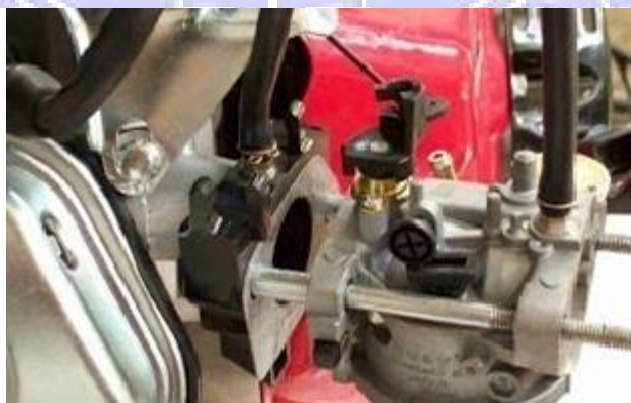
Gambar 3.14 Pemasangan Vacuum Valve dan Selang.
