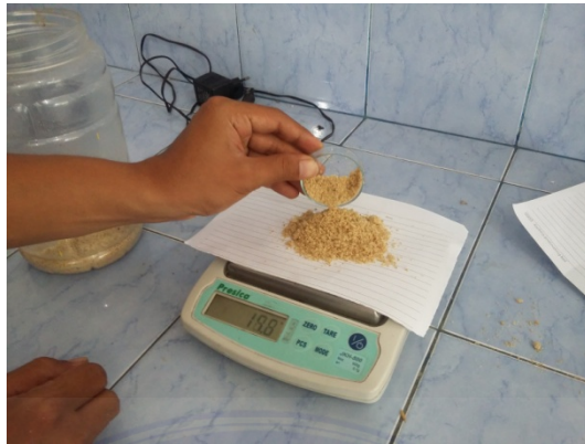
Gambar 3. Penimbangan Tepung Biji Jarak Pagar dengan Menggunakan Timbangan Digital (Sumber : Foto Penelitian)
