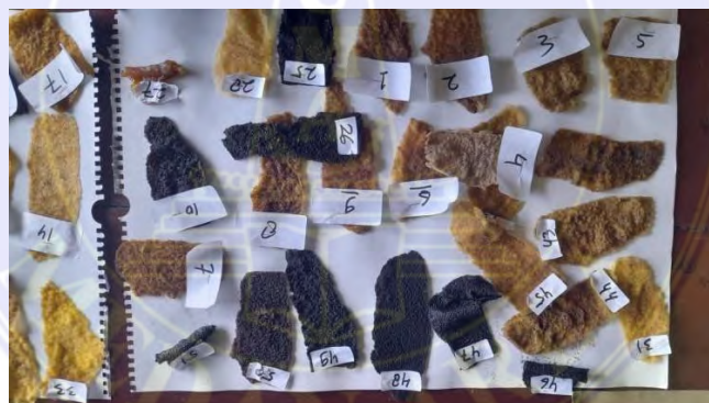
Gambar 4. Hasil analisis Kadar Karet Kering (KKK) di laboratorium Sungei Putih yang sebelumnya dilakukan pengeringan dan penggilingan
