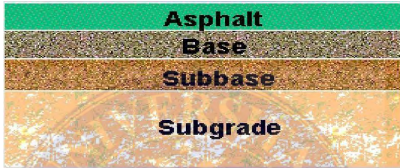
Gambar 2.1 Susunan Kontruksi Perkerasan Lentur Sumber:
