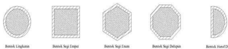
Gambar 13. Bentuk Pondasi Sumuran (Bowles, 1991)
