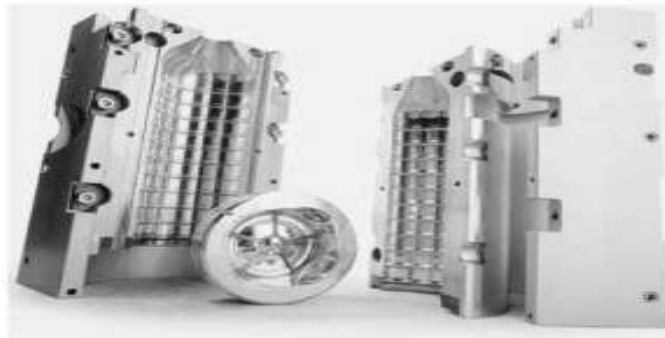
Gambar 2. 13. Mold Cavity Dari Blow Molding (Brandau, O. 2016)
