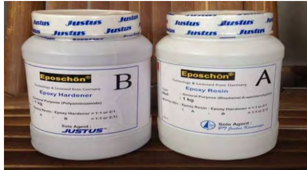
Gambar 3. 2. bahan matric komposit resin Epoxy dan katalis ( hardener )
