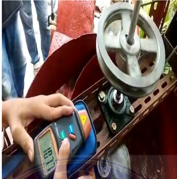
Gambar 3. 16. Pengambilan Kecepatan Putaran Turbin Dengan Terhubung Generator
