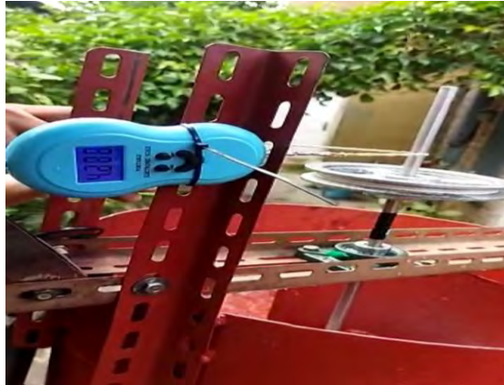
Gambar 3. 20. Proses Pengambilan Data dengan Metode Prony Brake
