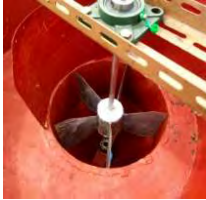
Gambar 3. 15 Memasang Sudu Tipe Vortex
