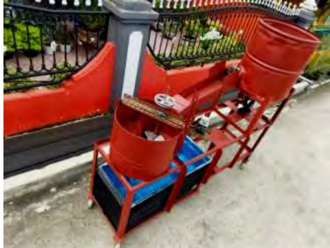
Gambar 3. 6 Pembangkit Listrik Jenis Turbin Whirlpool
