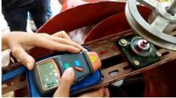
Gambar 3. 17 Melakukan Pengujian Pada Putaran Turbin Dengan Menggunakan Alat Ukur Tachometer
