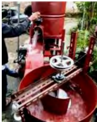
Gambar 3. 19 Membuka Pintu Air
