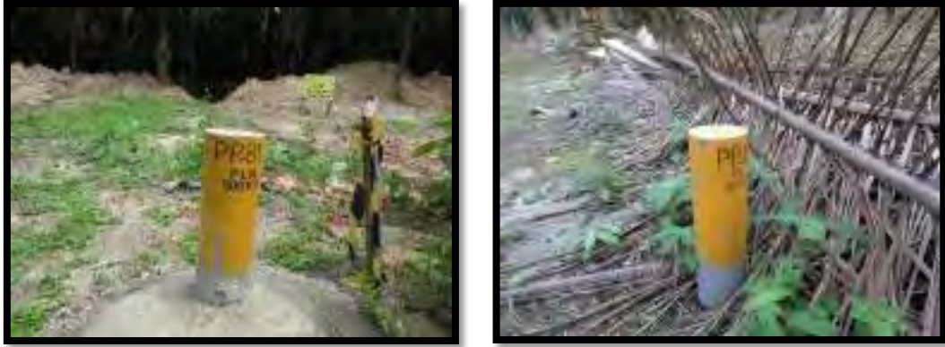
Gambar 3.2. Titik tower Kontrol Lapangan yang digunakan Sumber: Laporan Survey Pemetaan PT. Waskita Karya
