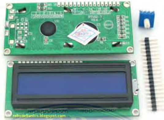
Gambar 2.2. Bentuk fisik dari lcd 2x16
