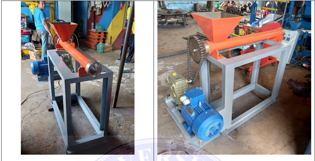
Gambar 4.9 Sistem injection molding setelah dicat tampak depan dan belakang
