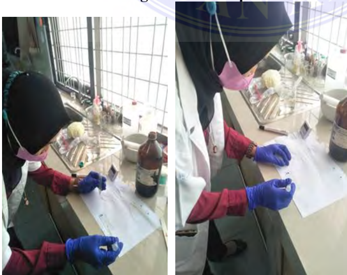
Gambar 13. Pengambilan 1 tetes endapan diletakkan diatas objek glass (a) dan diberi 1 tetes lugol diatas sampel kemudian tutup dengan cover glass (b)
