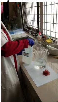
Gambar 5. Penyiapan larutan NAOH 0,2% dengan menambahkan 500ml aquadest
