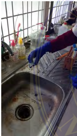
Gambar 12. Pembuangan bagian supernatan setelah selesai dicentrifuge
