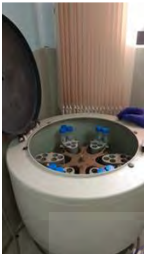
Gambar 11. Tabung dicentrifuge dengan kecepatan 1500 rpm selama 15 menit
