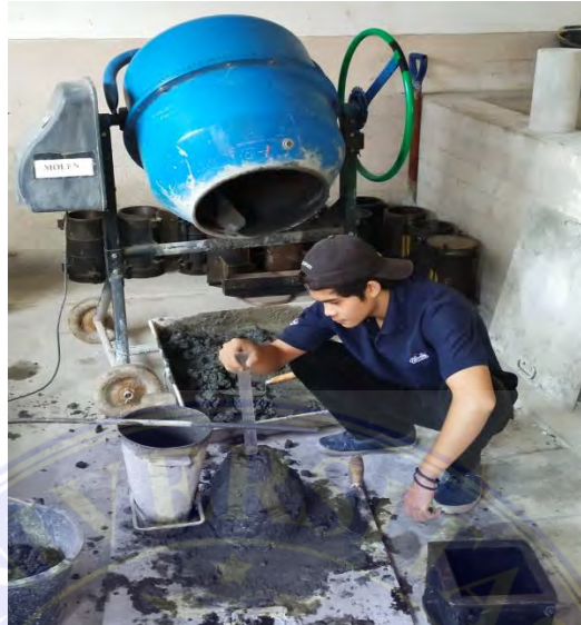
Gambar 3.12 Pengujian slump Sumber : Dokumentasi penelitian, 2022
