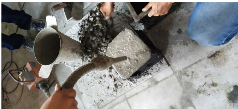
Penggunaan concrete vibrator Sumber : Dokumentasi, 2022
