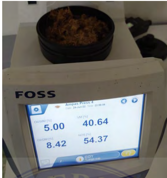
Gambar 3.4. Proses Pengujian Cangkang dan Fiber
