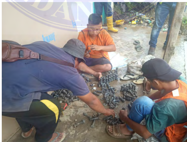
Gambar 9. Pengecekan Baut Baja
