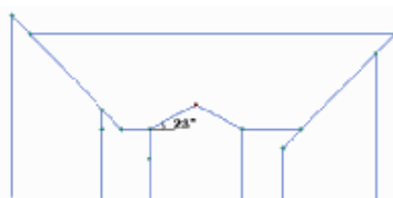
Figure 2 : Transformer core type 23° T-joint
