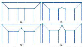
Fig. 1: Transformer core type (a) T-joint 90°, (b) Tjoint 23°, (c) T-joint 45° and (d) T-joint 60°
