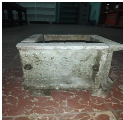
Gambar 3. 2. Cetakan spesimen benda uji.
