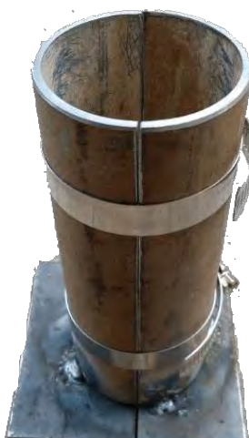
Gambar 3.1. Cetakan spesimen uji tekan
