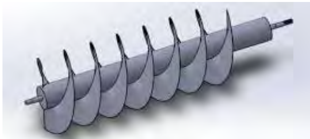
Gambar 2.4. Poros dengan ulir yang sudah terpasang.
