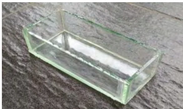
Gambar 3.20 Cetakan kaca pembuatan handle rem sepeda motor
