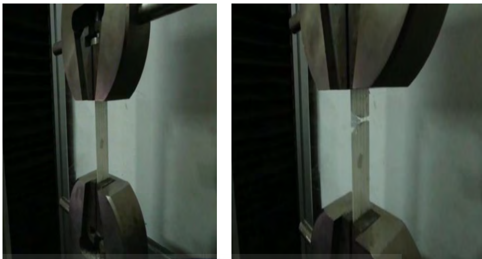
Gambar 3.18 Proses pengujian tarik
