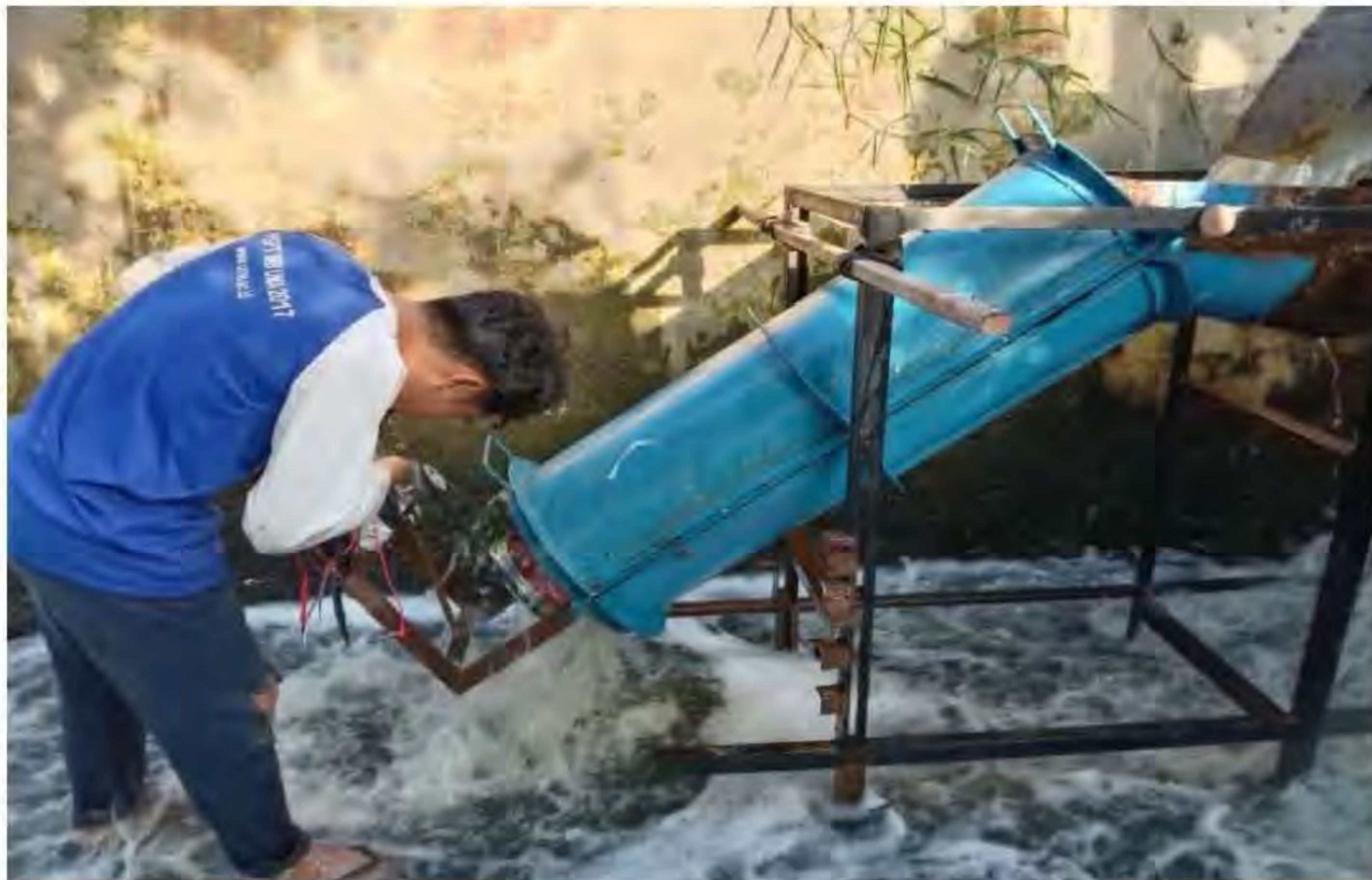
Gambar 3.10 Pengukuran Putaran Poros Turbin Ulir dan Generator
