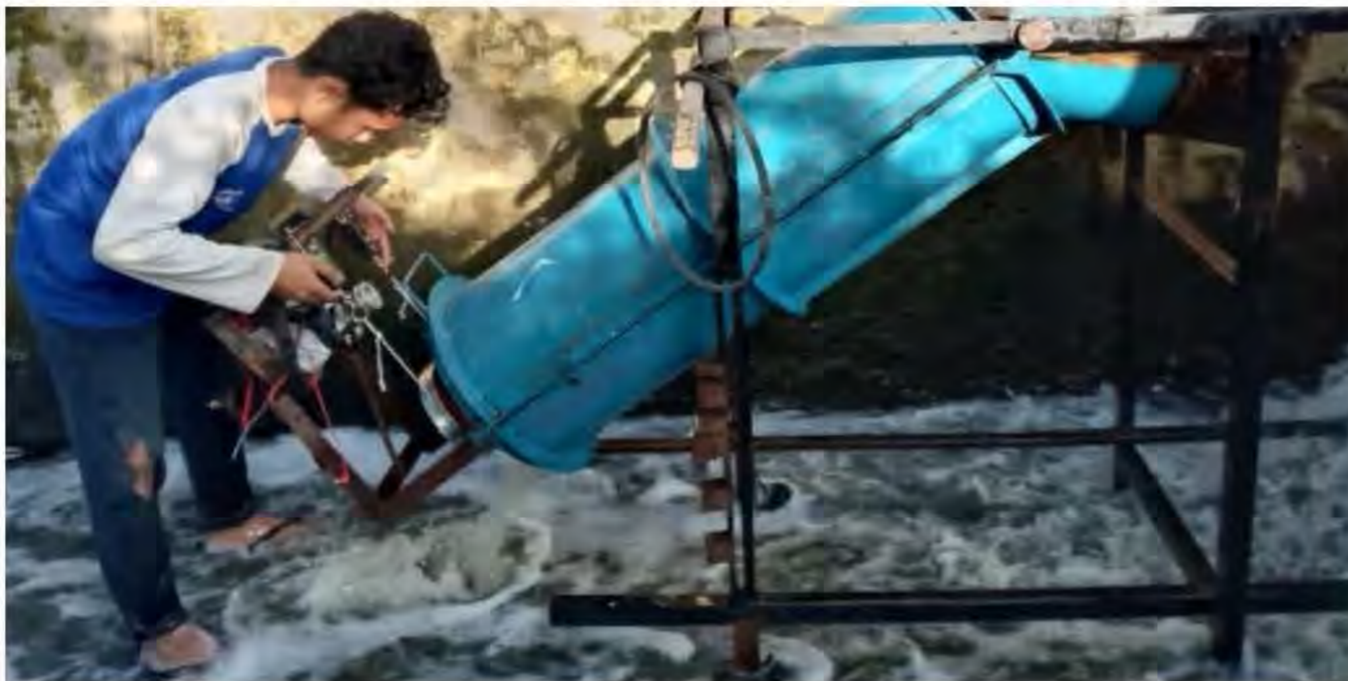
Gambar 3.12 Menghitung Torsi Poros Turbin Ulir
