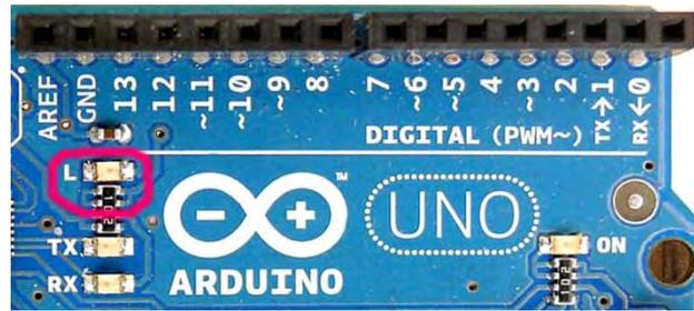
**Gambar 2.3: Tampilan keempat *LED* di *Arduino***
