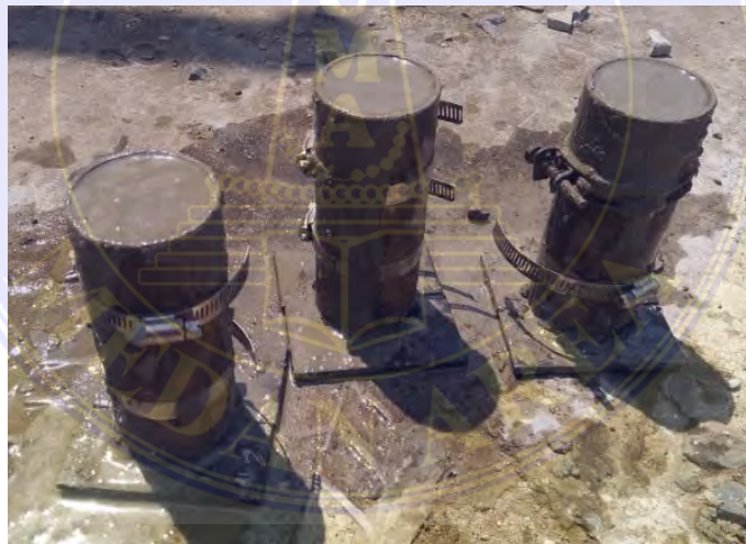
Gambar 3. 10. Agregrat beton yang telah dituangkan ke dalam cetakan
