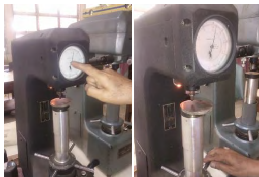
Gambar 3.5 Memasang bahan uji pada mesin uji rokwell
