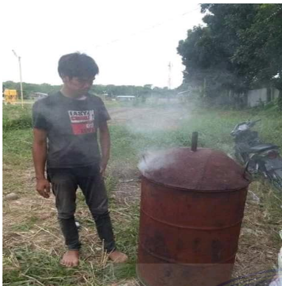
Proses Pembakaran Secara Tabung Pirolisis yang Telah Di Modifikasi
