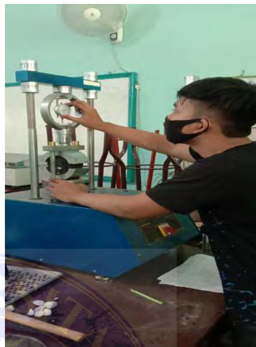
Gambar 28. Sampel diuji dengan Marshall.
