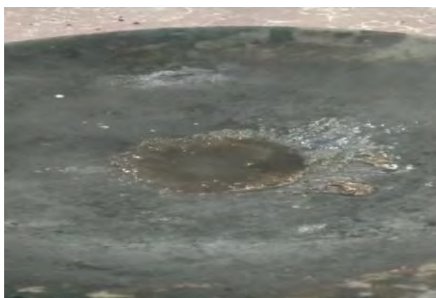
Gambar 3.2 Bahan Styrofoam Yang Telah Dilelehkan Bersamaan dengan Bitumen .
