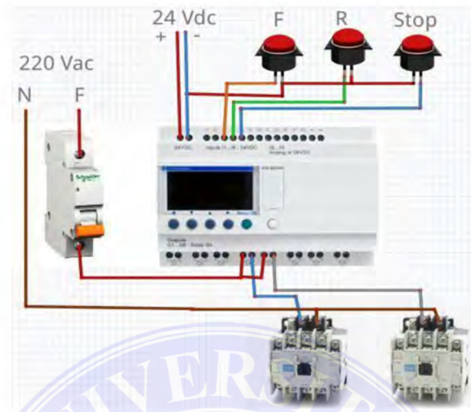
Gambar 3.14 : Pengawatan forward – reverse
