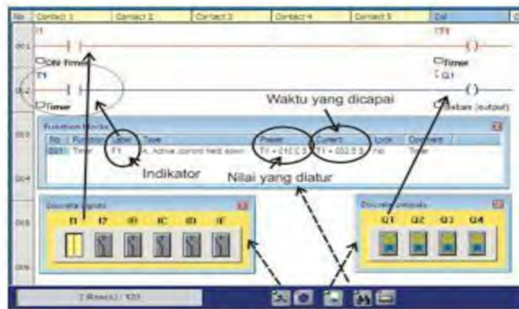
Gambar 2.7: Tampilan simulasi program dengan timer Function A
