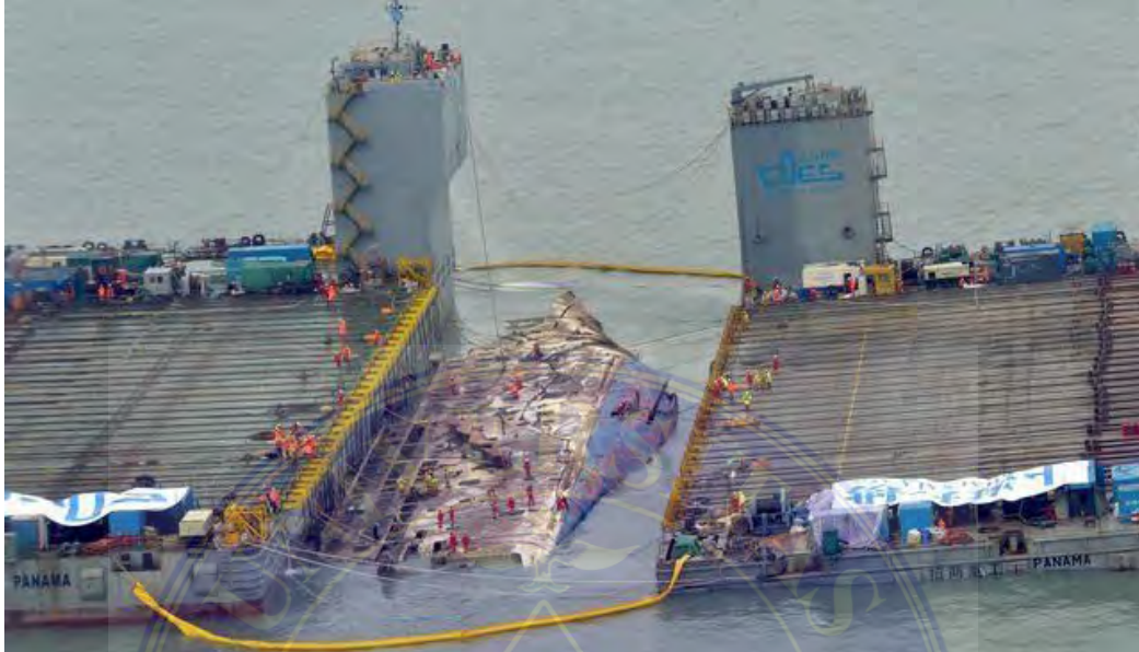
Gambar 3.2: Metode pengangkatan bangkai kapal menggunakan kapal floating barge mobile
