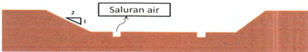
Gambar 4.18 Sketsa galian badan jalan dibuat saluran air
