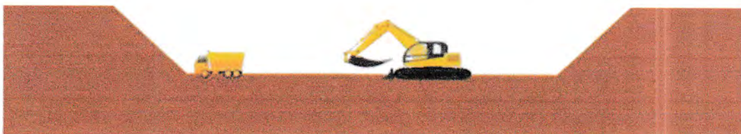
Gambar 4.17 Sketsa Galian dengan menggunakan excavator
