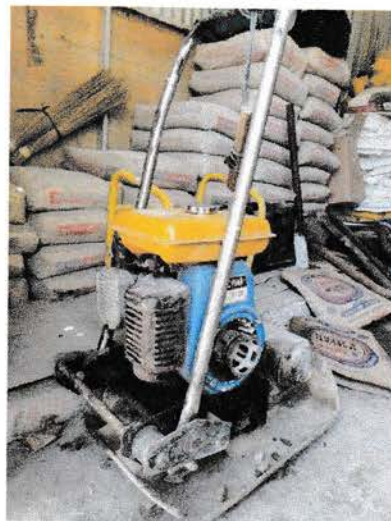
Gambar 3.8 Plate Compactor (Sumber : dokumentasi lapangan)
