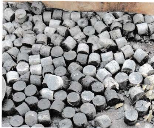
Gambar 3.13 Beton Decking (Sumber : dokumentasi lapangan)
