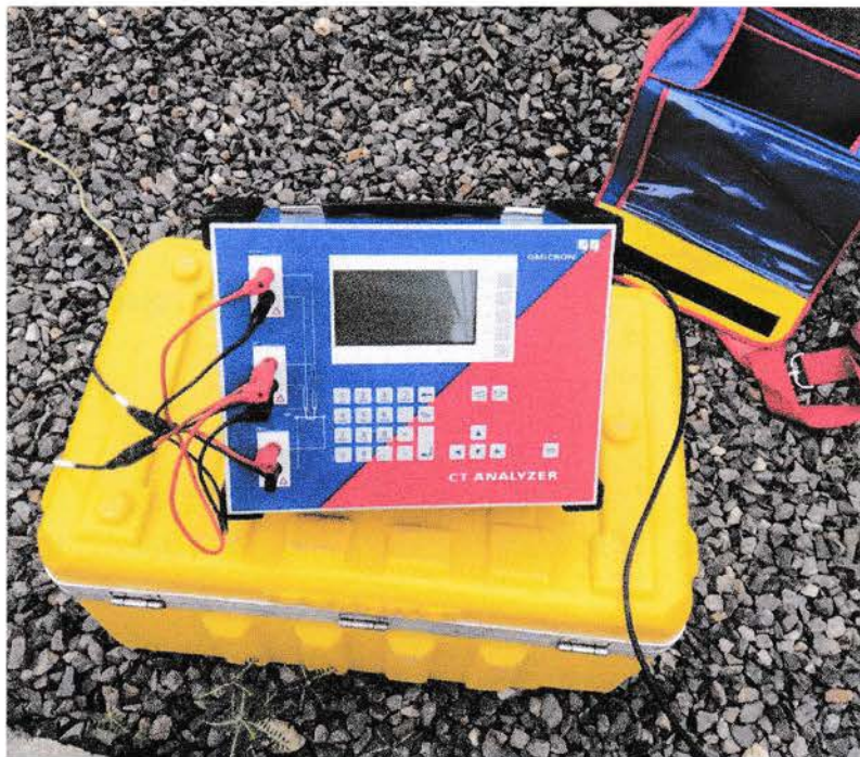
Gambar 4.12 Alat Ukur Ratio pada CT (CT Analyzer)
