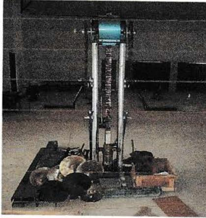
**Gambar IV.1 Mesin Sondir**
