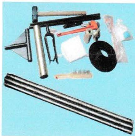
**Gambar IV.3 Perlengkapan Sondir**
