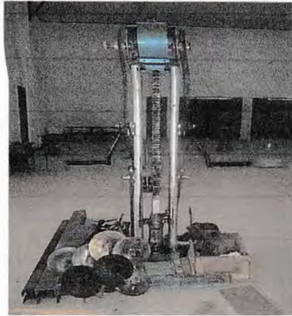
**Gambar IV.1 Mesin Sondir**
