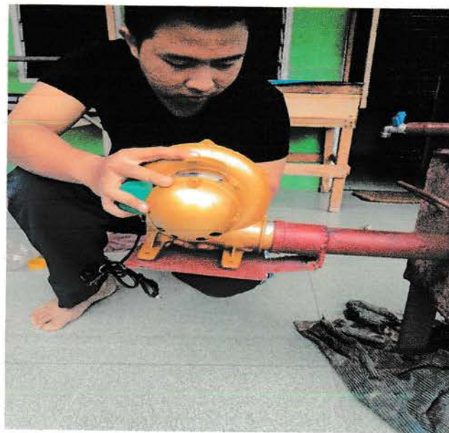
Gambar 4.2.2.7 pemasangan blower pada ruang bakar
