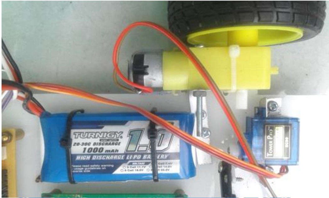
Gambar Baterai kotak merek Turnigy dengan tegangan 11,1 Volt yang terpasang pada Alat Sistem Pengecat Marka Jalan
