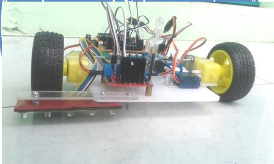
Gambar Alat Sistem Pengecat Marka Jalan Tampak depan ketika Tidak Bergerak (Diam)
