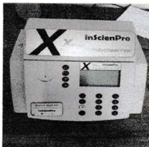
Gambar 2.2 Spektrofotometer (Alat untuk menganalisa TSS)
