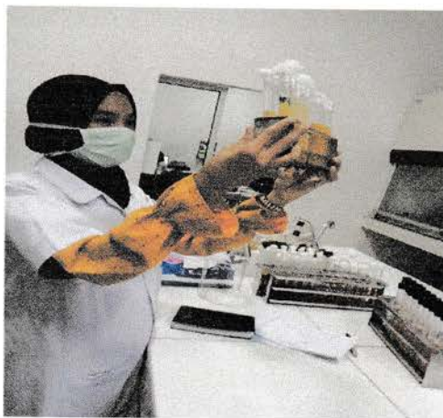
Gambar 2.16 Mengamati hasil pengujian total coliform pada contoh uji
