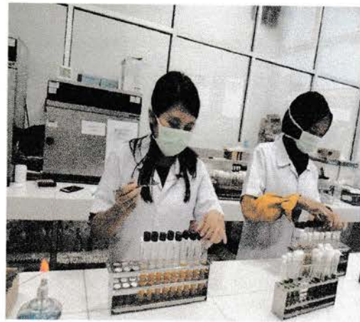
Gambar 2.14 Memasukkan contoh uji kedalam tabung reaksi yang sudah berisi media
