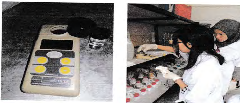
Gambar 4.6 Alat Turbidimeter beserta proses kerja menganalisa kekeruhan contoh uji dilaboratorium kimia
