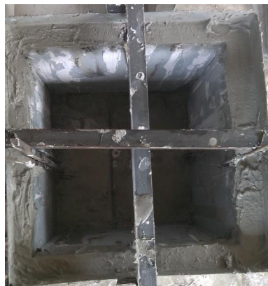
Gambar 3.4 pengecoran dinding alat uji
