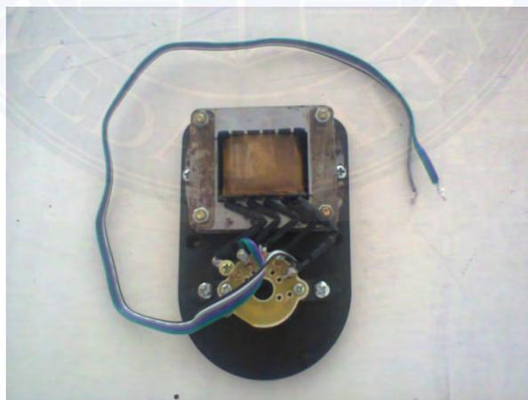
**Gambar 3.3: Sistem modifikasi *rotary switch***
