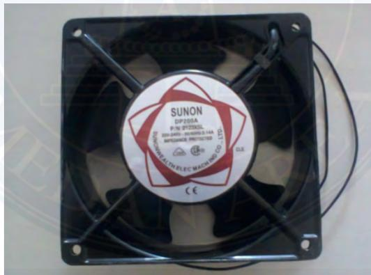
**Bentuk fisik motor induksi 1 fasa yang digunakan pada penelitian**
