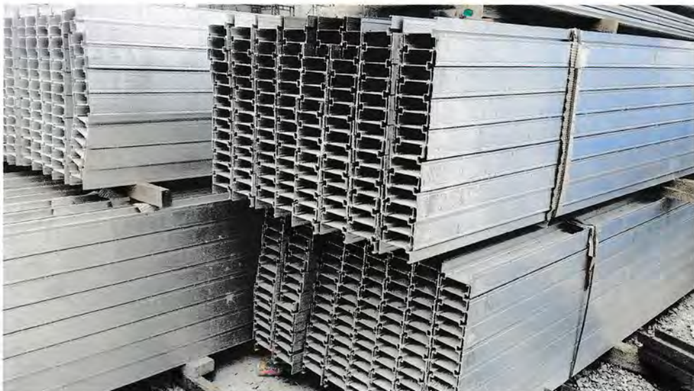
Gambar 4.8 Baja Ringan Aluma Girder Sumber : Dari lapangan Tahun 2015
