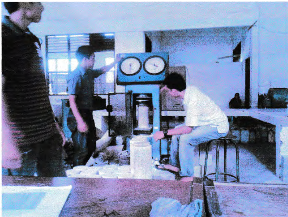
Gambar 21. Pengujian test kuat tekan beto
