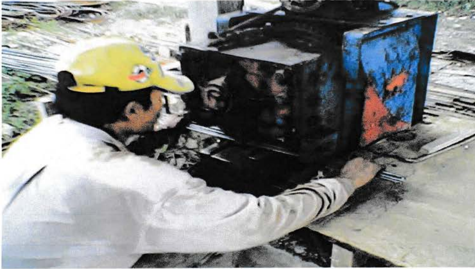
Gambar. 3.2.1.5. Alat Pemotong Besi
