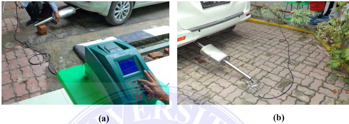
Gambar 3.14. (a) dan (b) Proses pengujian gas asap pada mesin otomotif jenis mobil minibus
